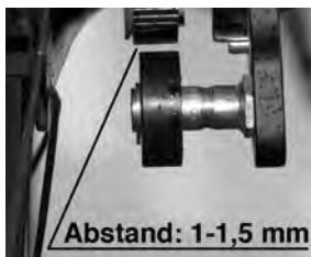
Abbildung 2: Die Snubber-Rolle berührt den Riemen nicht!
