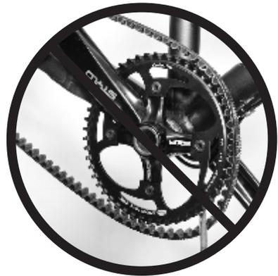
**Montage des Riemens unter Spannung, mit einem Hebel und/oder durch Kurbelumdrehung.**
