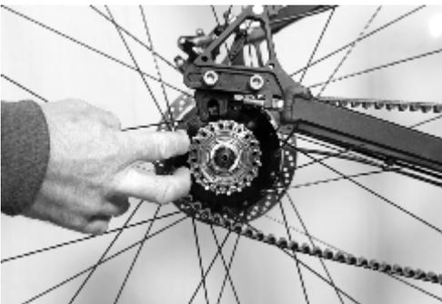
3. Legen Sie den Riemen auf die Zahnriemenscheibe des Hinterrades und montieren Sie das Hinterrad in den Ausfallenden.
