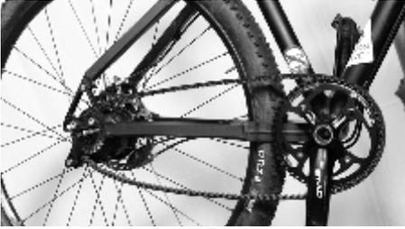
4. Verringern Sie den Abstand zwischen Tretlagerachse und Hinterachse soweit, dass sich der Riemen ohne Spannung auf die vordere Riemenscheibe auflegen lässt. Die technische Ausstattung, um den Abstand zwischen Tretlager und Hinterachse zu verringern, kann sich je nach Fahrradhersteller unterscheiden. Folgen Sie hierzu immer
