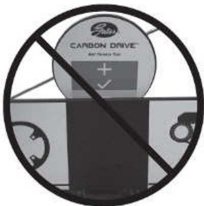
**Abbildung 2: Zu hohe Riemen Spannung**
