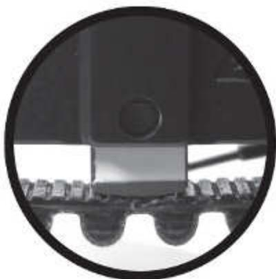
**Abbildung 3: Optimale Riemen Spannung**
