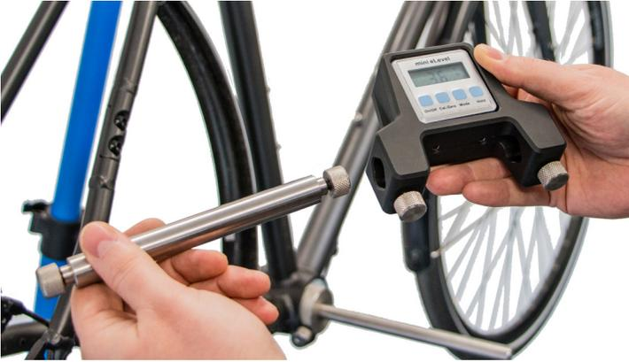
Abbildung 4: Messachse wird in Winkelsensor eingesetzt
