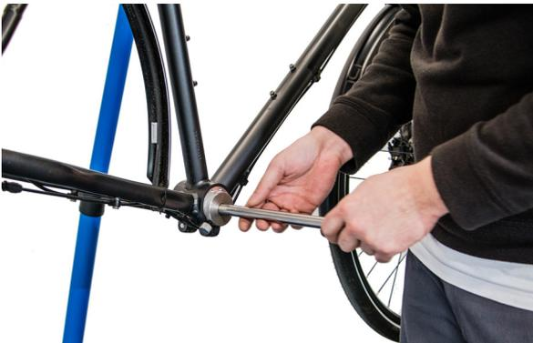
**Abbildung 2: Montage der Tretlager-Messachse**
