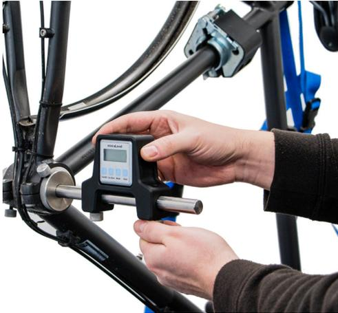
**Abbildung 1: Lotrechte Ausrichtung der Winkelsensoren**
