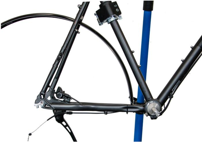
**Abbildung 1: Ausrichten des Rahmens im Montageständer**
