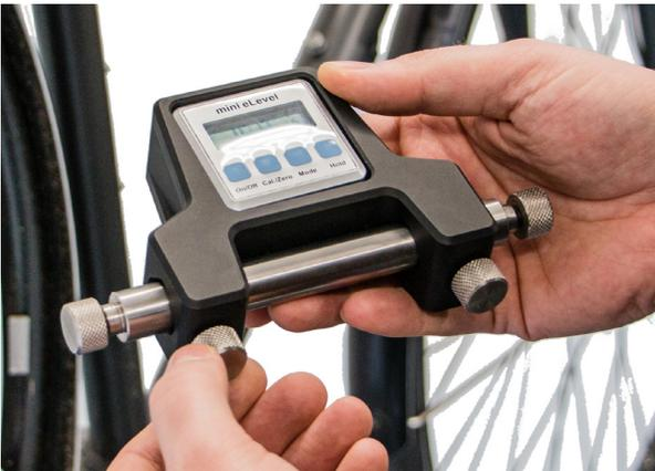
Abbildung 5: Messachse wird am Winkelsensor fixiert
