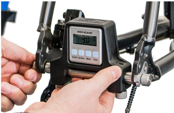
**Abbildung 6: Montage des Winkelsensors am Hinterbau**
