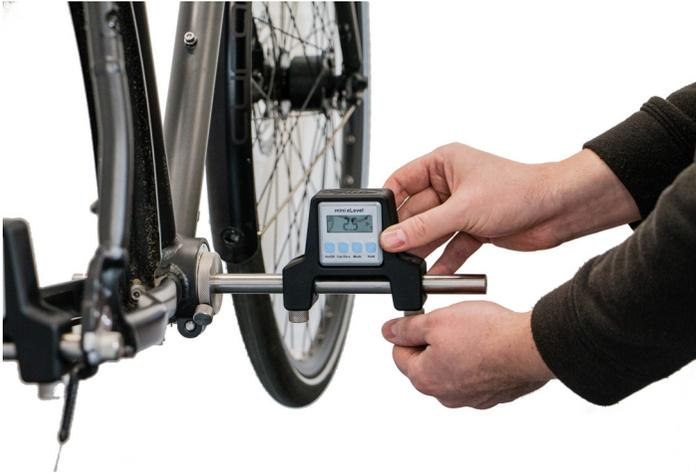
**Abbildung 3: Montage des Winkelsensors**
