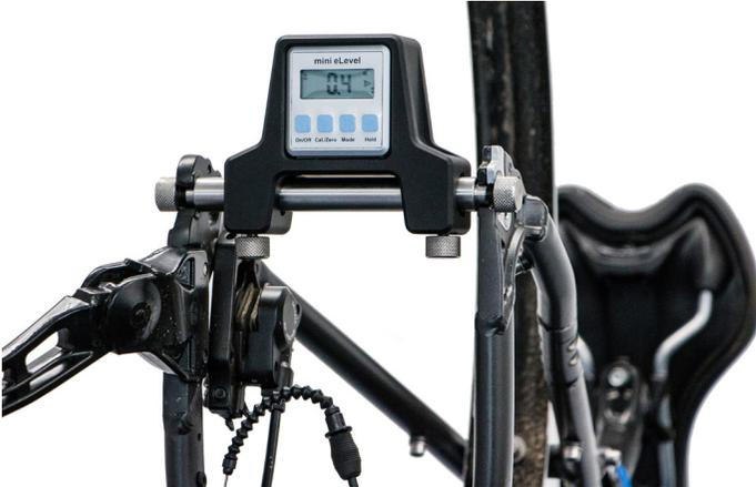
**Abbildung 1: Ablesen des Messergebnisses an der Hinterachse**
