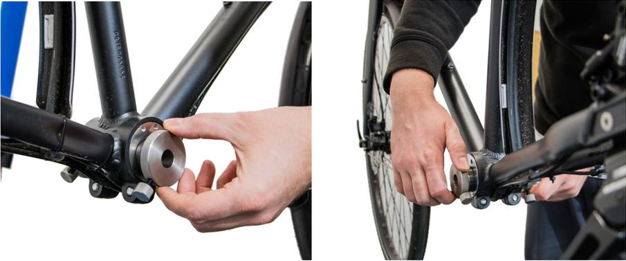
**Abbildung 1: Montage der Tretlager-Adapter am Rahmen**
