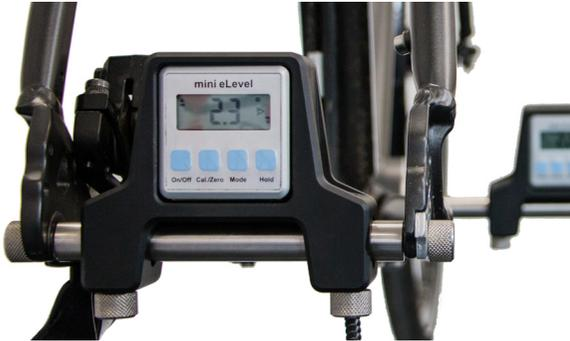
**Abbildung 1: Ablesen des Messergebnisses an der Hinterachse**
