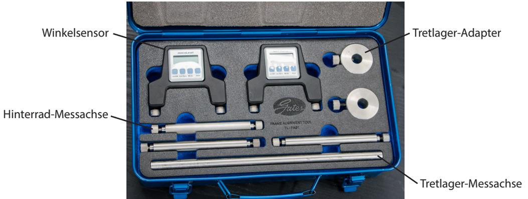
**Abbildung 1: Lieferumfang des Frame Alignment Tools**
